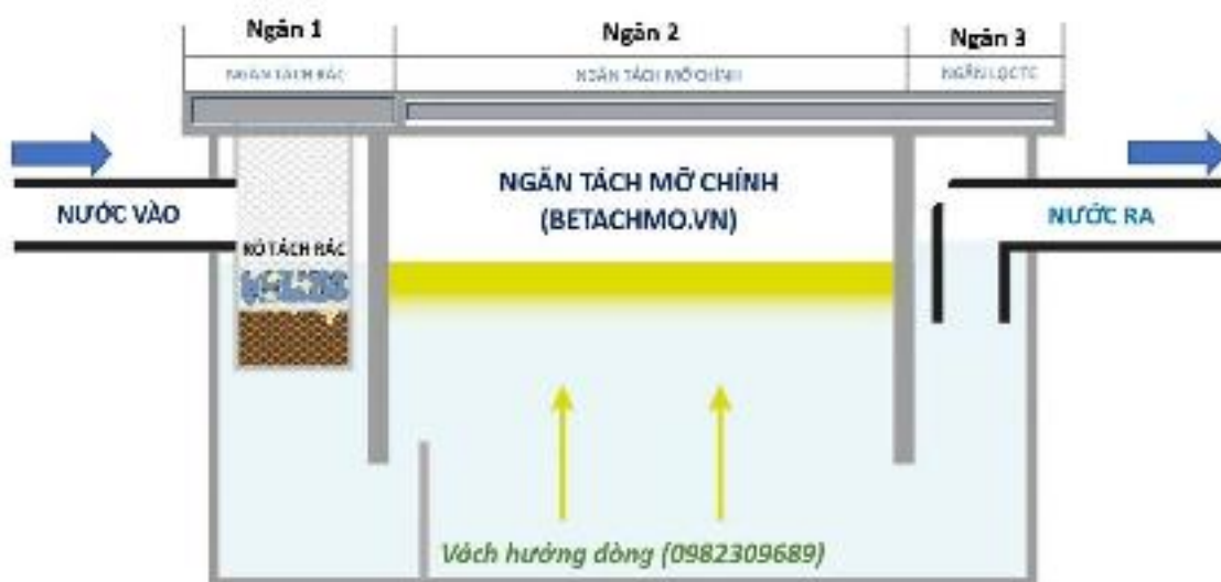
Hình 4.4. Bố trí tách mỡ dầu và rác thải trong hệ thống xử lý chất thải rắn
